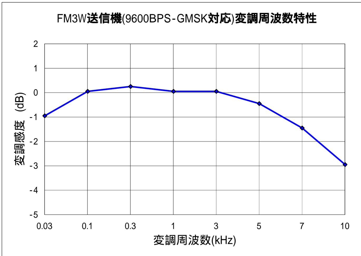
注) 変調信号周波数1kHzで、 $\pm 1.5$ KHzの変調度を基準に測定。
