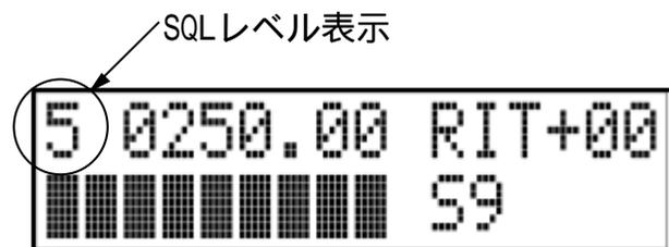
上記の例では ' 5 ' なのでアナログメーターが5以下でスケルチが動作します。
